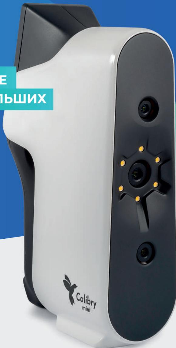
Легкий и быстрый, Mini обеспечивает высокое качество данных, захватывая самые сложные детали. Устройство может оцифровывать традиционно сложные черные и блестящие поверхности, а также острые края.
